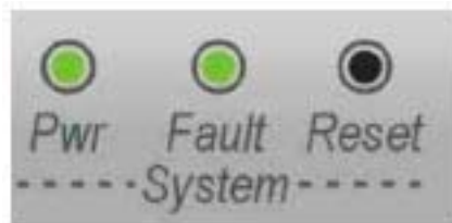
Рис.10. Светодиодные индикаторы и кнопка Reset системной секции
