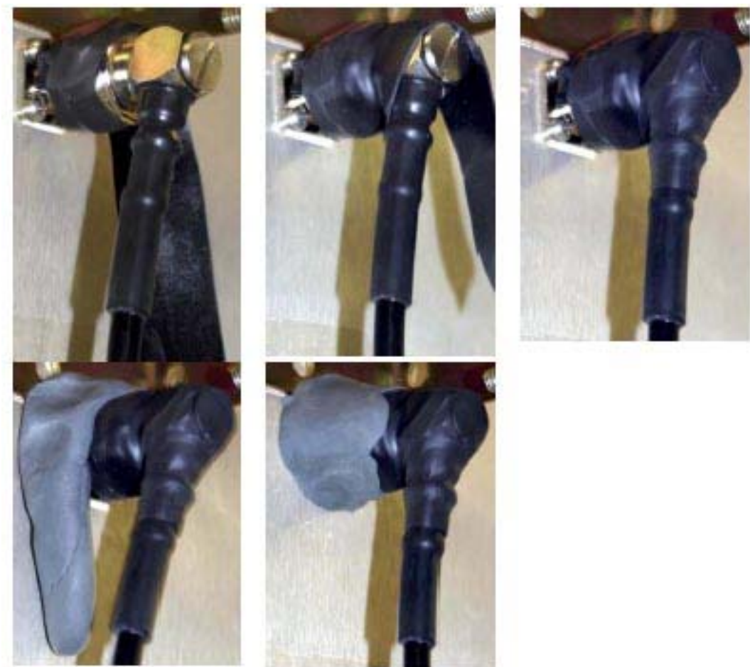
Рис.21. Гидроизоляция внешних соединений
