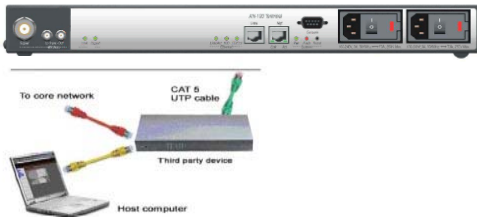
Рис.14. Подключение хост-компьютера к системе Nateks-Multilink 3
