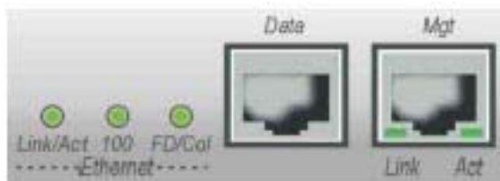
Рис.9. Светодиодные индикаторы и порты RJ-45 секции Ethernet на передней панели
