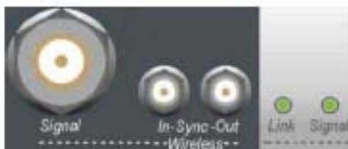
Рис.8. Секция радиоканала на передней панели
